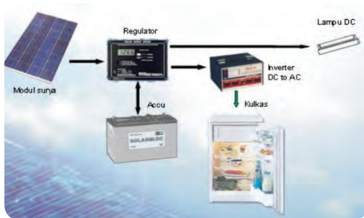
Gambar 2.5 Komponen konversi energi surya menjadi energy listrik
